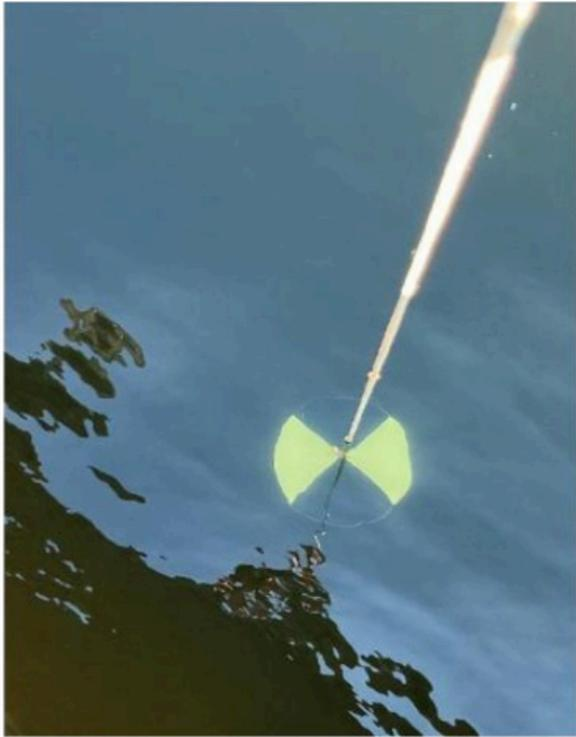
*Photo : Disque de Secchi*
